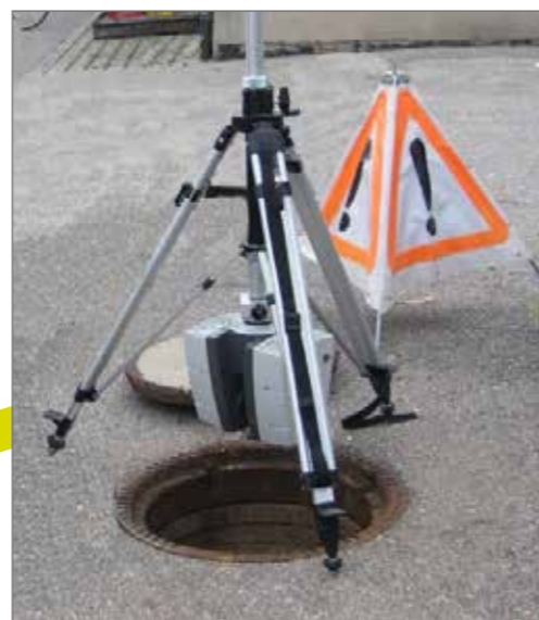
Detailliertes Schachtaufmaß idealerweise mittels Schachtschan
