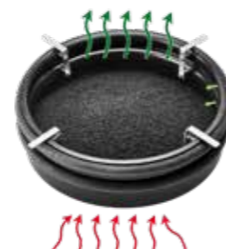
Wirkschema des ROMOLD Activ-Filter für Kanalschächte
