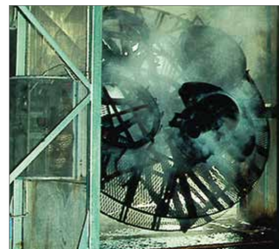
ROMOLD Produktion im Rotationssinterverfahren (Kühlung mit Wasser)
